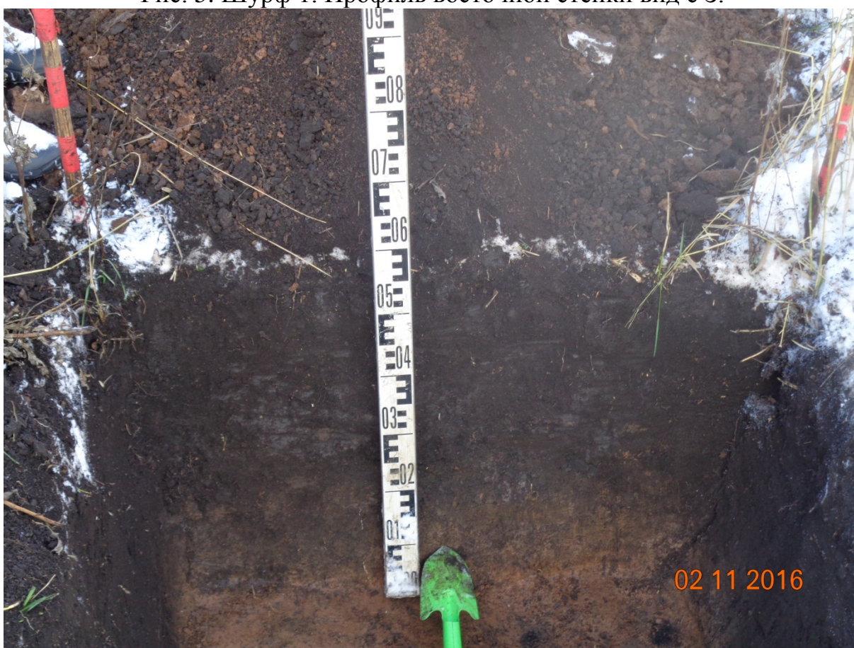
Рис. 6. Шурф 1. Профиль северной стенки после прокопки материка.
